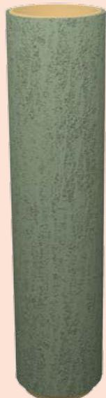
Innenrohre aus korrosionsfreier Keramik mit Muffenverbindung. Die Innenrohre sind 100 cm lang und ab Werk mit einer Dämmschale versehen
