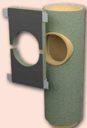
Rauchrohranschluss aus Keramik mit werksseitig vormontierter Dämmung aus hydrophobierter Mineralwolle. Eine Frontplatte zum Verschluss der Mantelsteinöffnung erleichtert das Verputzen des Schornsteins.
