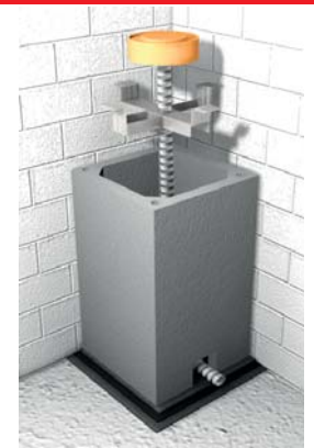
Detail Deckendurchgang Holzdecke (Vereinfacht)
